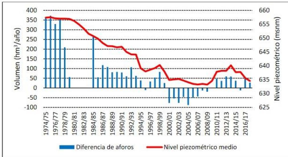
Figura 103. Evolución de los niveles piezométricos medios anuales en el punto 08.29.035 junto a la diferencia entre los volúmenes aforados entre las estaciones 08036 Alcalá del Júcar y 08129 El Picazo.
